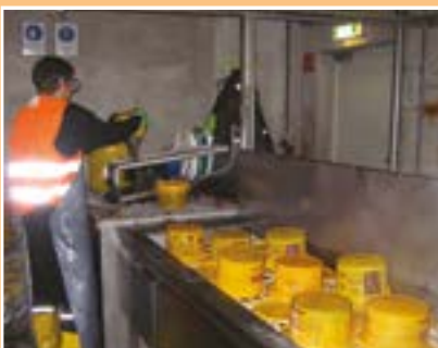
Die NÖLIs werden händisch geöffnet und entleert. Das Öl läuft in einen Auffangbehälter.
