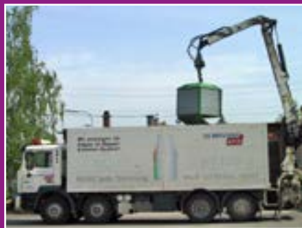
Die Behälter werden entleert. Die Ladefläche des LKWs ist in zwei Kammern geteilt – eine für Buntglas, eine für Weißglas.
