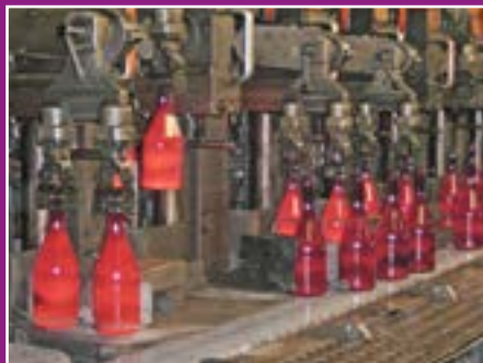
Glühende Glastropfen kommen in eine Vorform und werden mittels Druckluft zu einer Flasche gegossen.
